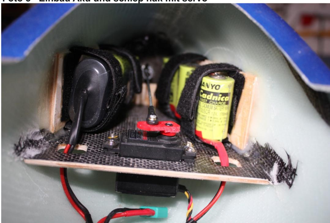
Foto 6 Einbau Empfänger platte
