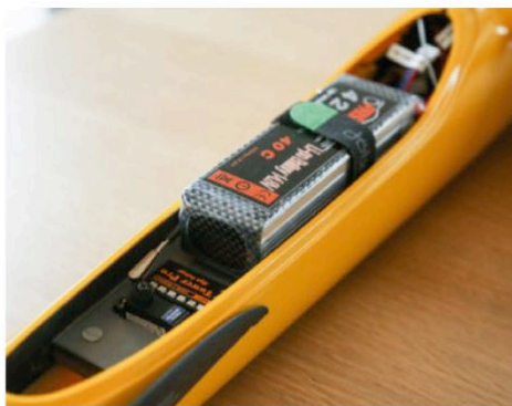
L'accus LiPo 4S de 4000 mAh se glisse sous la verrière au chausse-pied.
