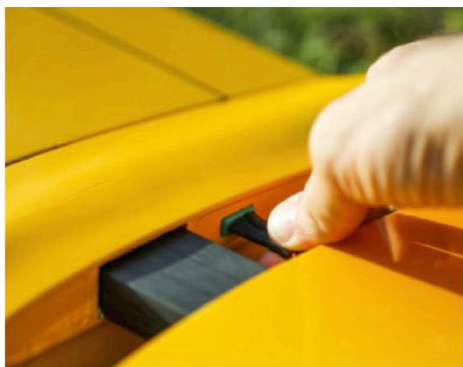
Seul le connecteur du fuselage est collé, celui de l'aile reste mobile.
