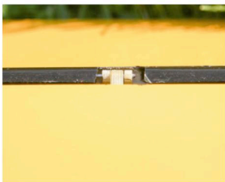
Une pince à bec et de la patience sont de rigueur pour installer la commande LDS dans l'aile. Malheureusement, l'absence de notice n'aide pas.
