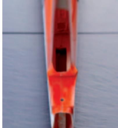
Ein Blick ins Seitenleitwerk. Gut zu erkennen: die Aussparung für das Seitenruder-Servo
