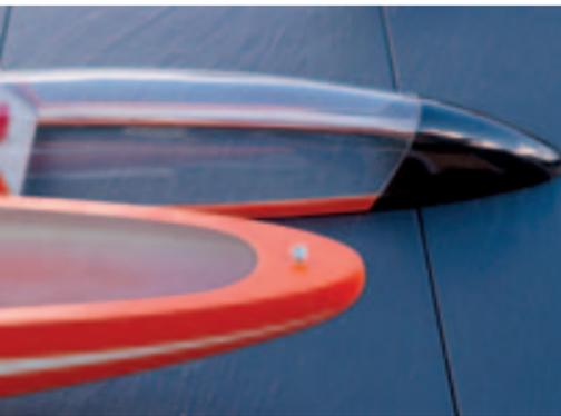
Die Kabinenhaube wird an einer Schraube arretiert
