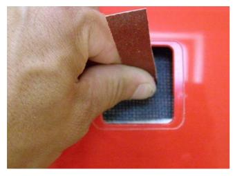
Schleifen Sie nun die Stellen, an denen die Servos später eingeklebt werden gründlich an, um eine gute Haftung der Klebestelle zu gewährleisten.
