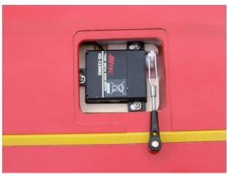
Setzen Sie nun die Servos samt Kabelbaum und Gestänge sauber mittig in den Schacht ein. Achten Sie dabei darauf, das Gestänge gerade zum Servoschacht auszurichten, um später einen reibungslosen Sitz der Servoabdeckung zu gewährleisten.
