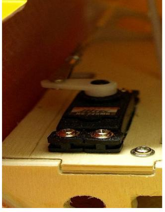
Um das Höhenruder anzulenken, längen Sie den eingefügten Bowdenzug entsprechend ab und justieren Sie das Höhenruder auf Nulllage.
