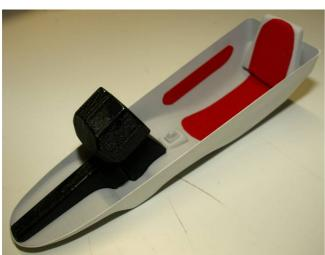
Schneiden Sie die ABS Teile für den Cockpitausbau zurecht, lackieren Sie diese und kleben Sie aus Samtstoff die Polsterflächen auf.
